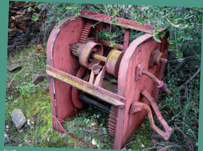
Sarilho, motor utilizado para puxar as vagonetas com minério do interior do poço de arrasto
